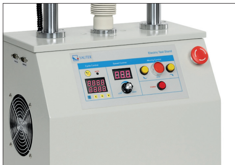
Premium-Bedienpanel - Digitale Geschwindigkeitsanzeige - Digitale Wiederholungsfunktion
